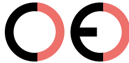
Falsche CE-Kennzeichnung (zu großer Zwischenraum)
