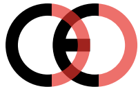
Falsche CE-Kennzeichnung (zu dicht)
